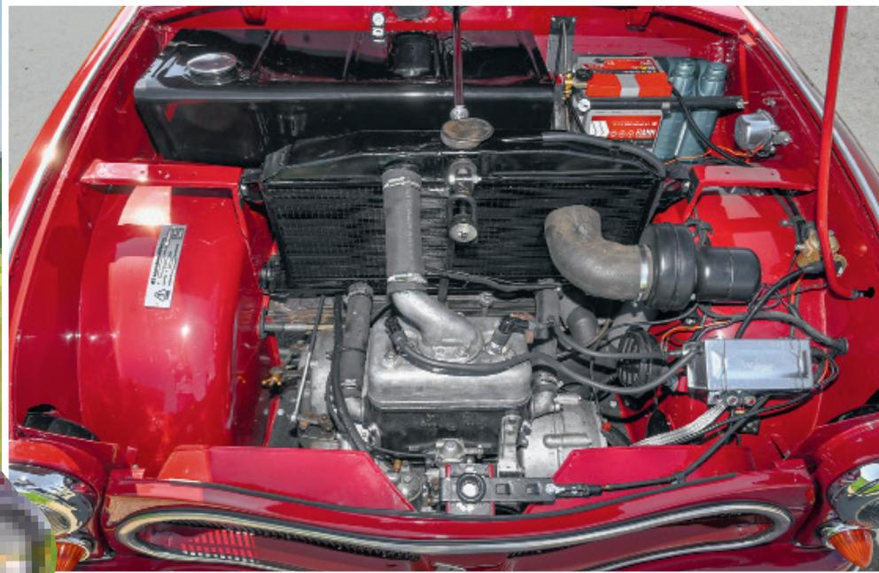
Der 700-Kubik-Zweizylinder ähnelt dem seit 1933 gebauten DKW-Meisterklasse-Zweitakter, ist aber um 180 Grad gedreht eingebaut
