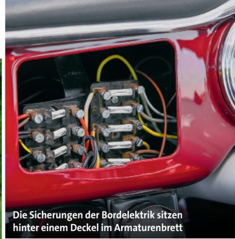
Die Sicherungen der Bordelektrik sitzen hinter einem Deckel im Armaturenbrett
