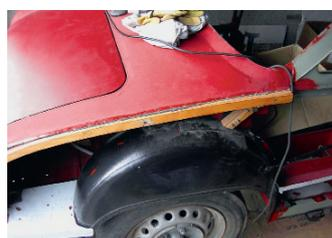
Holzplatten dienen als Verbindung von Blech- und Duroplastteilen
