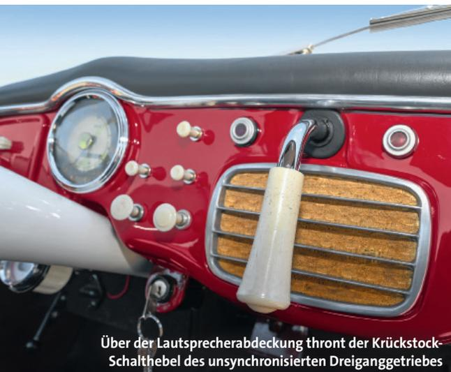
Über der Lautsprecherabdeckung thront der Krückstock-Schalthebel des unsynchronisierten Dreiganggetriebes
