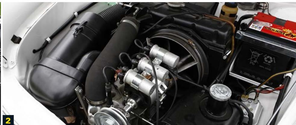
1 Alle Teile des Armaturenbretts waren beim Kauf noch vorhanden und wurden nur gereinigt 2 Auf dem Motor sitzen die drei Zündspulen 3 Etliche Zierteile wurden neu verchromt 4 Das zurückgeschlagene Verdeck verschwindet vollständig im Verdeckkasten 5 Die vier Auto-Union-Ringe zieren die Radkappen
